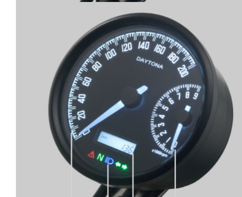
Compteur 200 KM/H, Ecran LCD, Témoins lumineux, Compte-tours 9 000 trs/min
