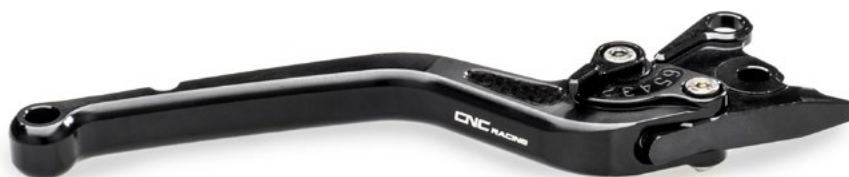
Leviers frein ou embrayage fixes longs (180 mm) avec insert carbone et réglage de garde
